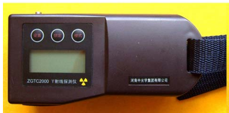
图 1 (在线彩图) 便携式γ射线违禁品探测仪
