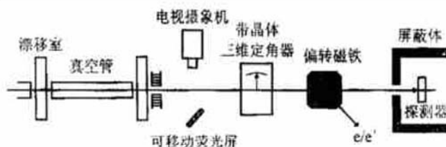
图4 沟道辐射实验装置示意图
