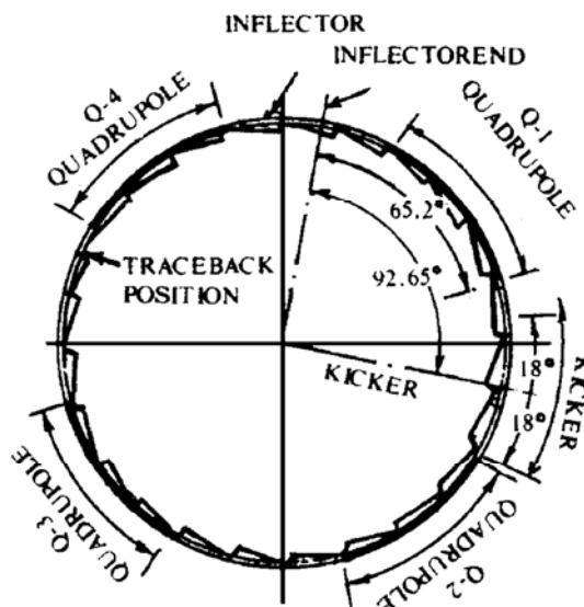
图示  $\mu$  介子储存环示意图
