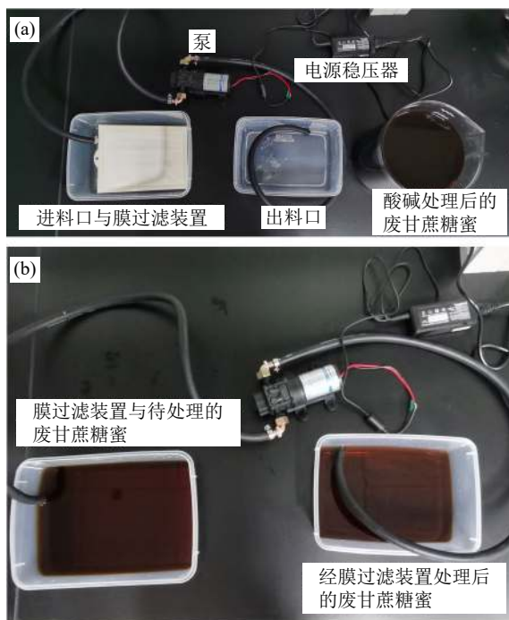
图2 重离子径迹蚀刻膜过滤装置(在线彩图)
