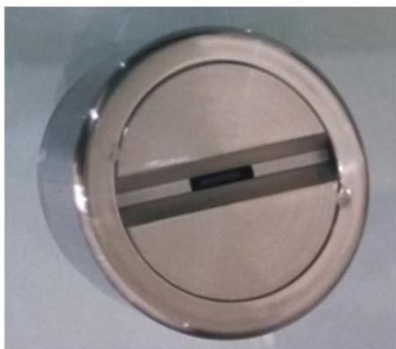
图 4 (在线彩图) 静电自会聚 LaB<sub>6</sub> 电子枪照片
