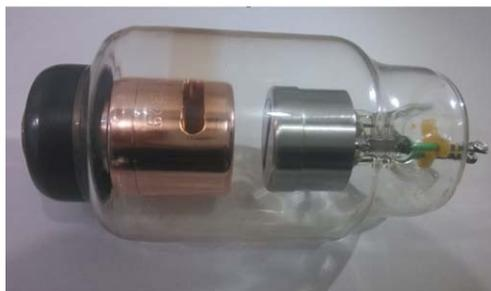
图 7 (在线彩图) 静电自会聚 LaB<sub>6</sub> X 射线管
