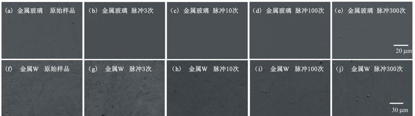
图 3 HIPIB 辐照不同次数前后 Zr_{53}Al_{23.5}Cu_{5.9}Co_{17.6} 金属玻璃和金属 W 的 SEM 表面形貌图
