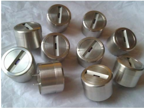
图 7 (在线彩图) LaB 6 静电自会聚电子枪照片
