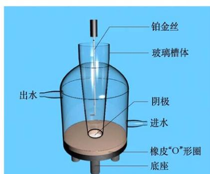
图 1 (在线彩图) 分子镀制靶实验装置图
