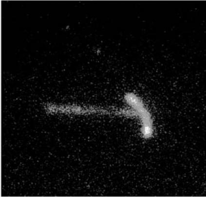
图 3 用 OTPC 观测到的<sup>45</sup>Fe 双质子衰变的径迹照片<sup>[11]</sup>
