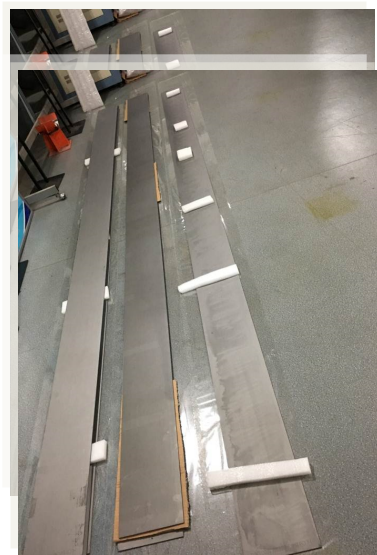
图8 整张乏燃料水池贮存格架用B 4 C-Al板
